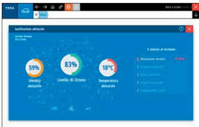
Grazie alla integrazione con AIR2 SAN, il software TEXA IDC5 acquista la capacità di comandare e controllare la sanificazione del veicolo.
